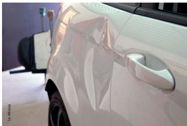
Na skutek samochodowego wandalizmu ucierpiała poszycie drzwi – także w miejscu przetłoczenia. Alternatywą szybszą i tańszą dla prac blacharsko-lakierniczych okazała się technologia PDR. Fachowcy z firmy MWalczak usunęli wgniecenie w ciągu 6 godzin.
