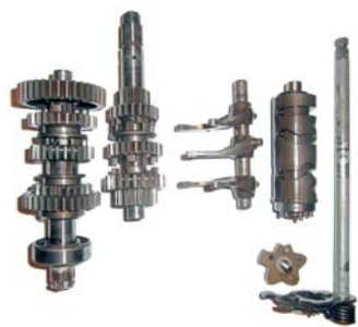
Dwuwalkowa skrzynia biegów z wodzikami i wałkiem sterowania wymontowana z motocykla.
